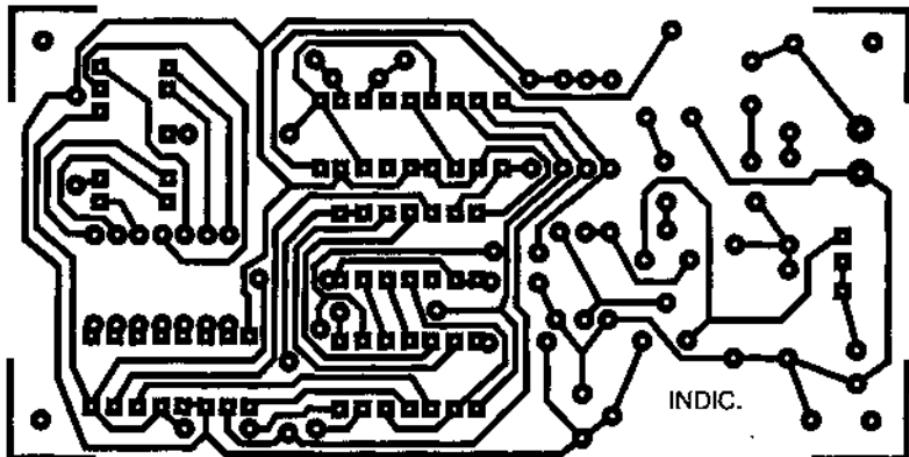
Рис. 4.129. Чертеж печатной платы цифрового индикатора телефонного набора
