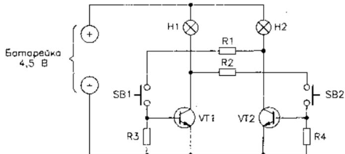
Рис. 4.4. Принципиальная схема «электронного арбитра»
