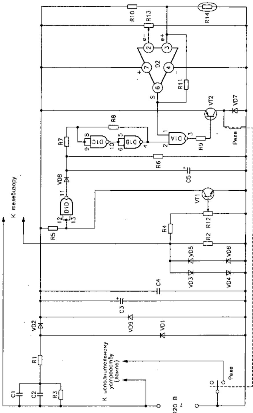
Рис. 4.117. Принципиальная схема автоматического устройства включения комфорtnого освещения
