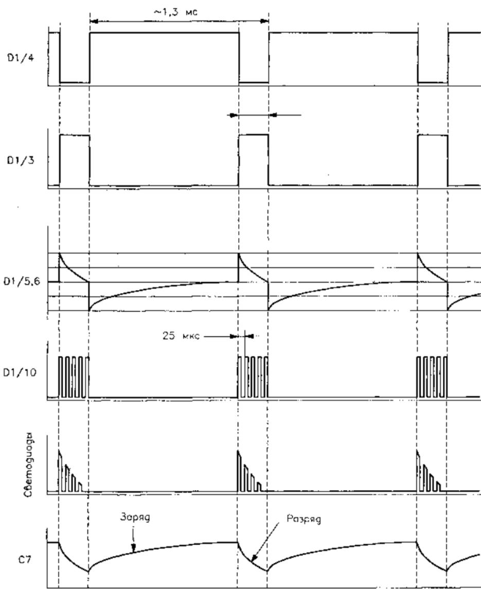
Рис. 4.86. Временная диаграмма работы излучателя инфракрасного барьера
