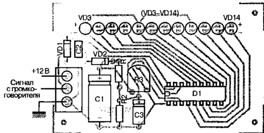
Рис. 4.74. Монтажная схема индикатора уровня сигнала
