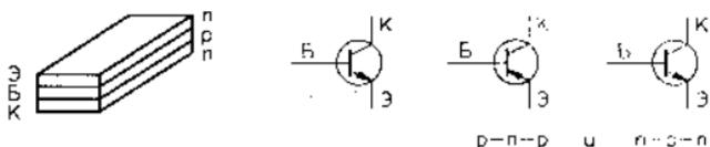
Рис. 1.12. Транзисторы  $p-n-p$  и  $n-p-n$
