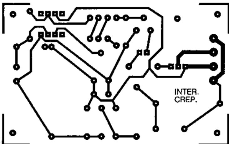
Рис. 4.97. Чертеж печатной платы автоматического выключателя
