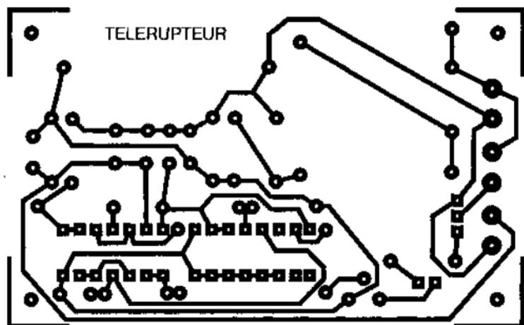
Рис. 4.55. Схема печатной платы сетевого дистанционного выключателя
