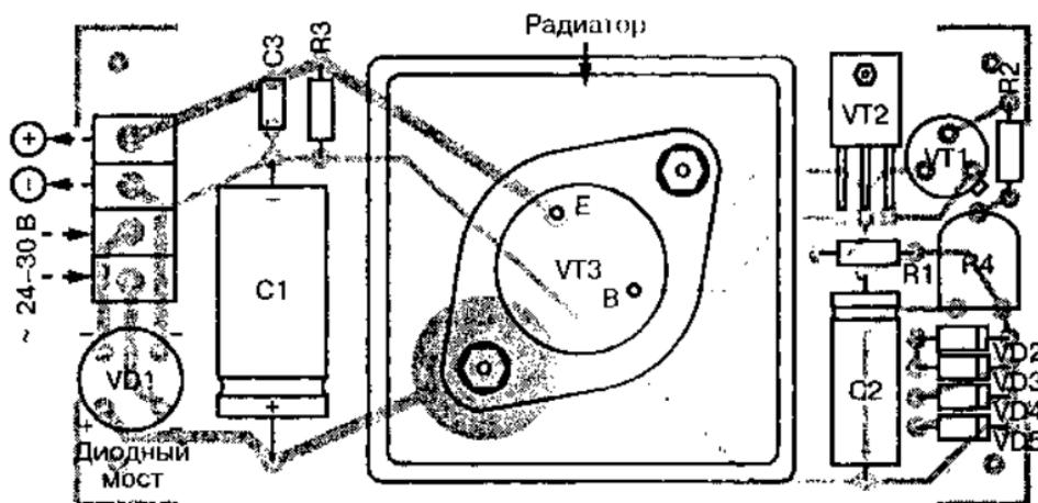
Рис. 4.3. Монтажная схема регулируемого источника постоянного напряжения
