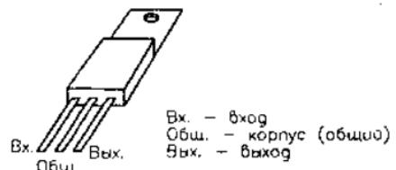
Рис. 3.3. Интегральные стабилизаторы напряжения
