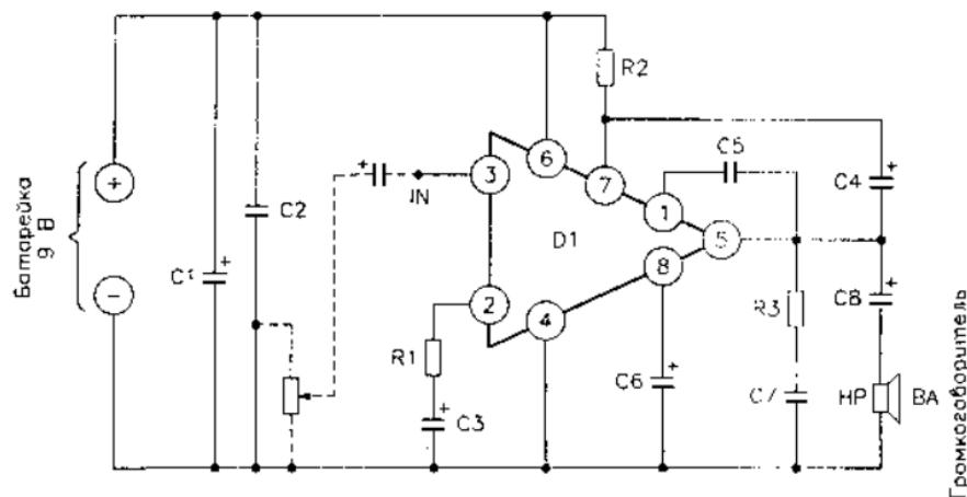
Рис. 4.63. Принципиальная схема низкочастотного усилителя
