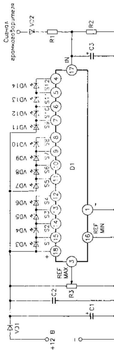
Рис. 4.72. Принципиальная схема индикатора уровня сигнала для автомагнитолы
