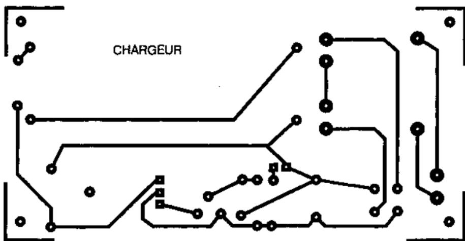
Рис. 4.29. Чертеж печатной платы зарядного устройства
