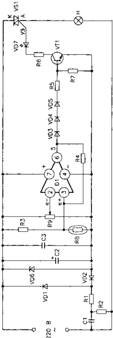
Рис. 4.95. Принципиальная схема автоматического выключателя, управляемого внешним освещением
