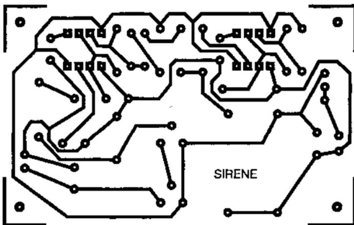
Рис. 4.26. Чертеж печатной платы электронной сирены
