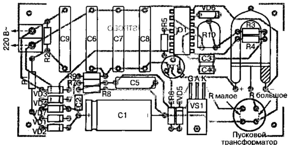
Рис. 4.61. Монтажная схема стробоскопа
