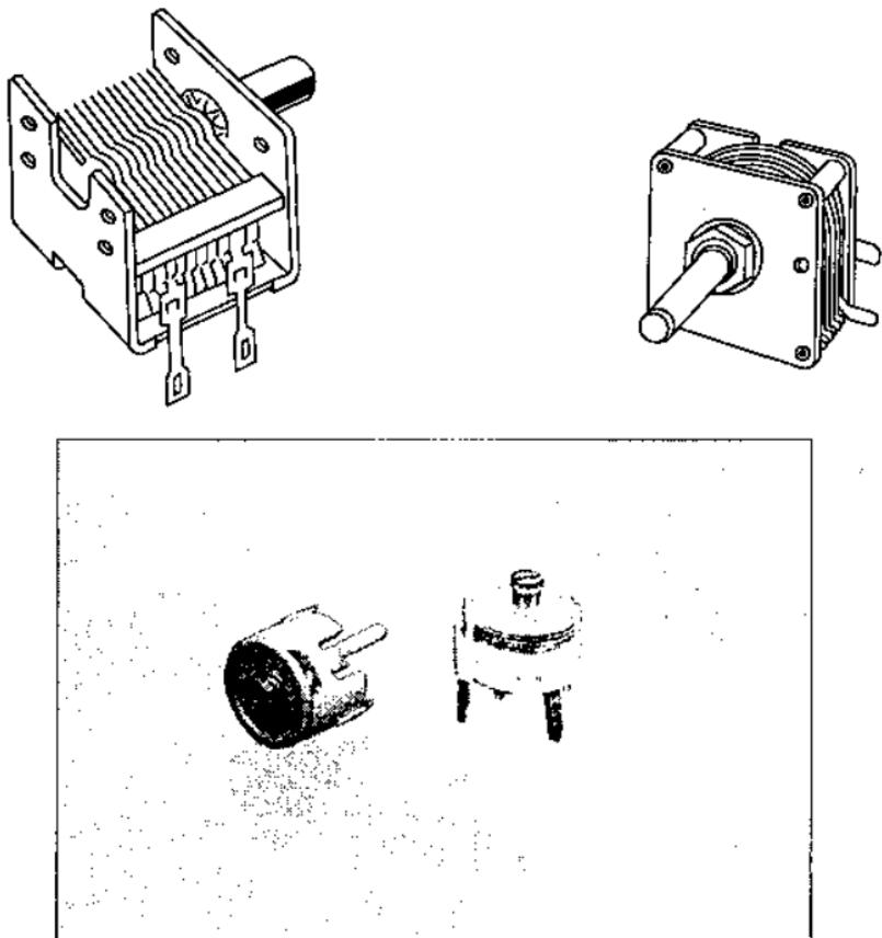
Рис. 1.5. Переменные конденсаторы
