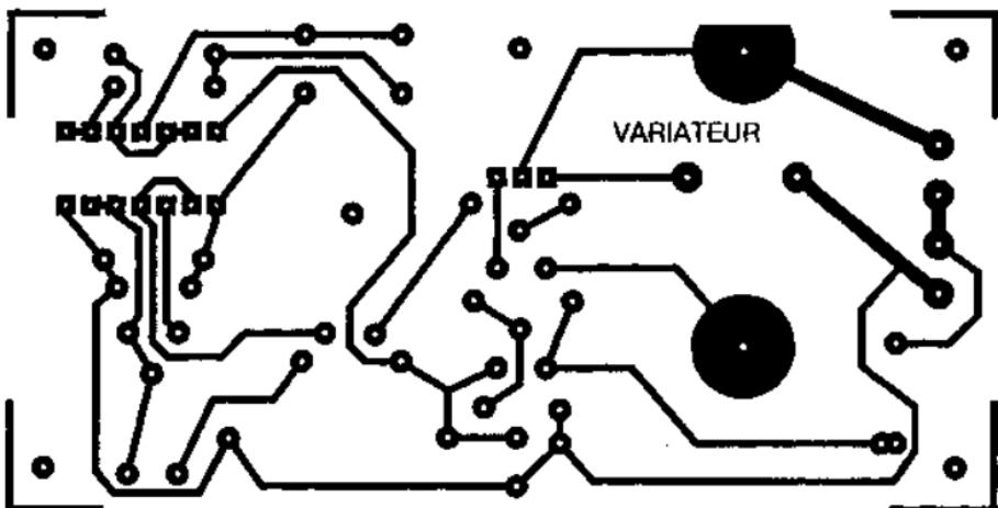
Рис. 4.51. Печатная плата регулятора скорости вращения дрели
