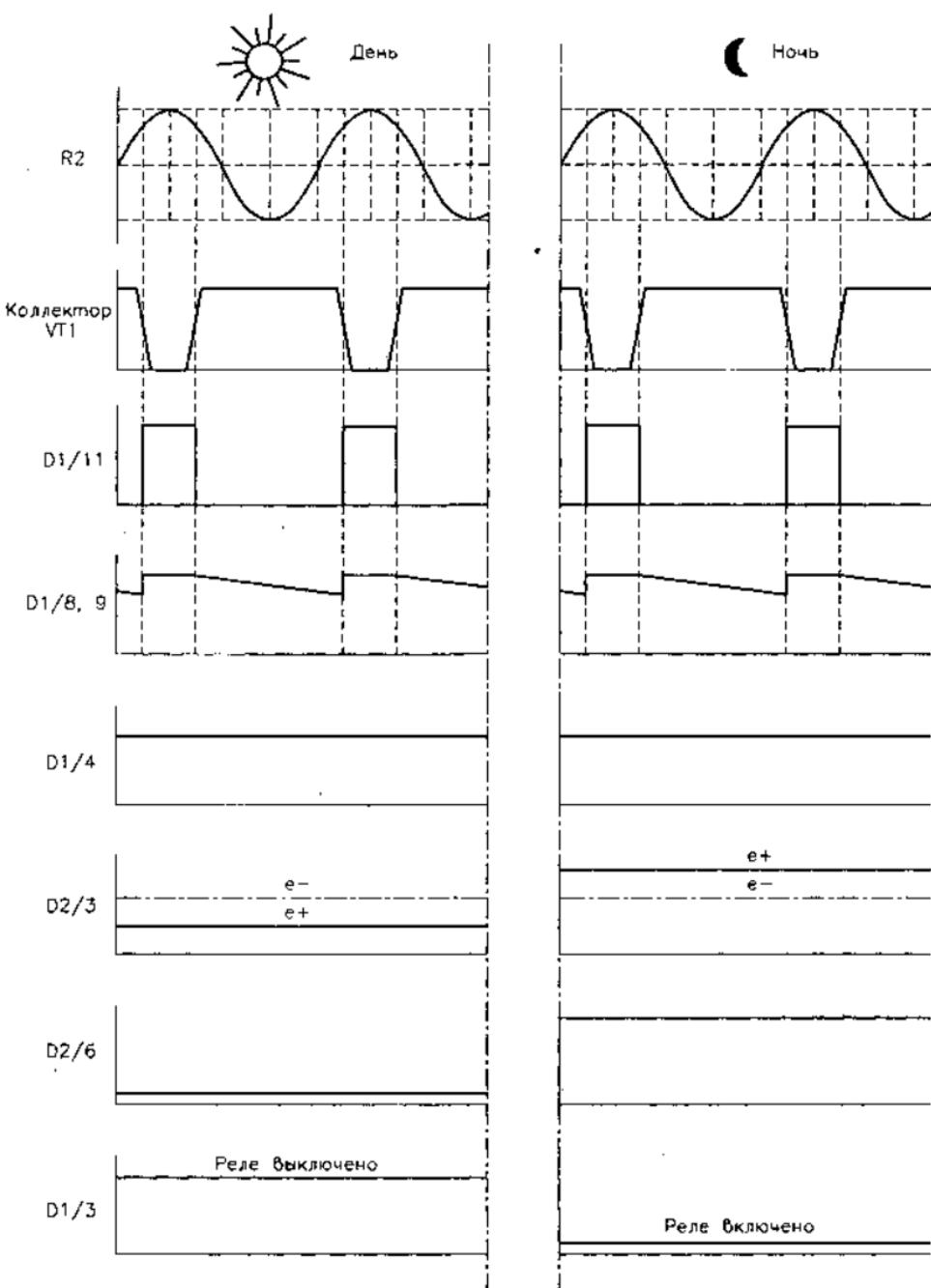
Рис. 4.118. Временная диаграмма работы автоматического устройства включения комфорта освещения
