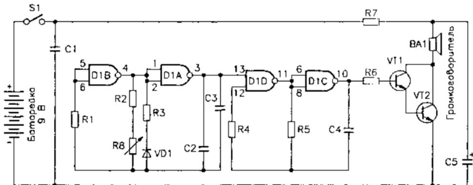
Рис. 4.80. Принципиальная схема метронома
