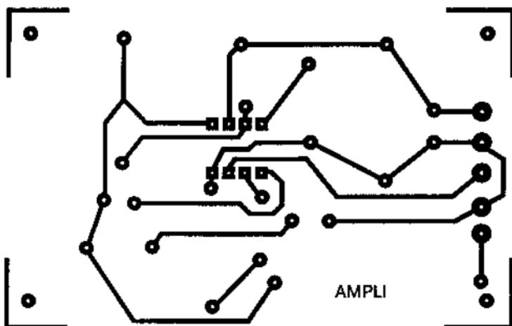
Рис. 4.64. Чертеж печатной платы низкочастотного усилителя
