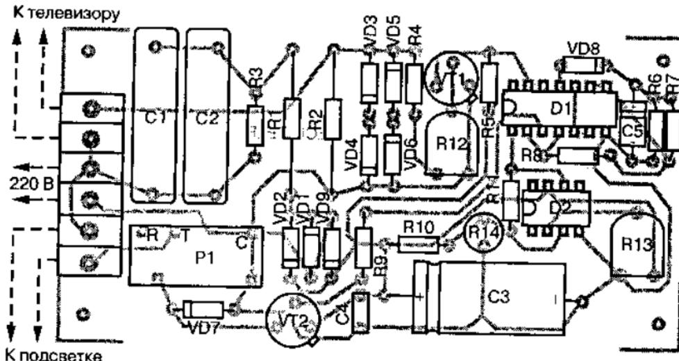
Рис. 4.120. Установка компонентов автоматического комфорtnого освещения на печатной плате
