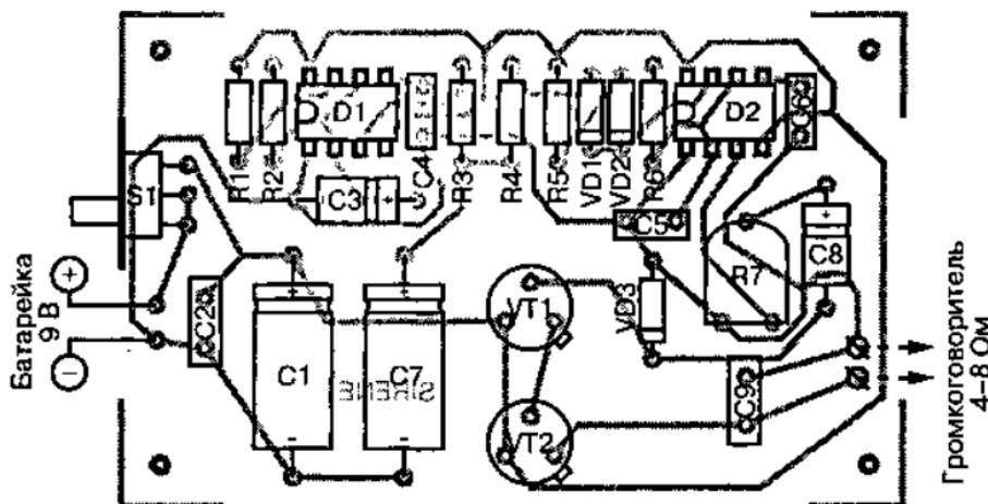
Рис. 4.27. Монтажная схема электронной сирены
