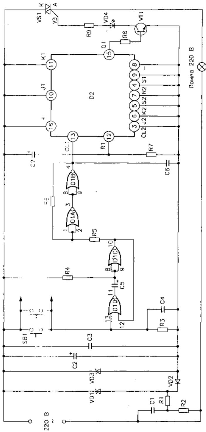
Рис. 4.53. Принципиальная схема сетевого дистанционного выключателя
