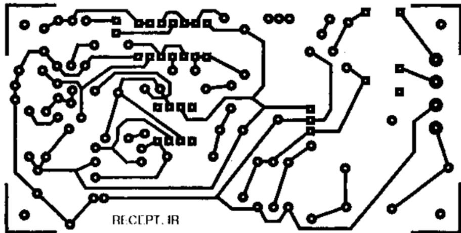
Рис. 4.92. Чертеж печатной платы приемника для инфракрасного барьера
