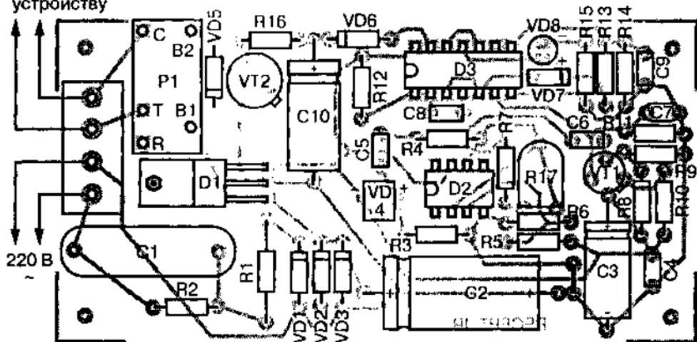
Рис. 4.93. Монтажная схема приемника для инфракрасного барьера
