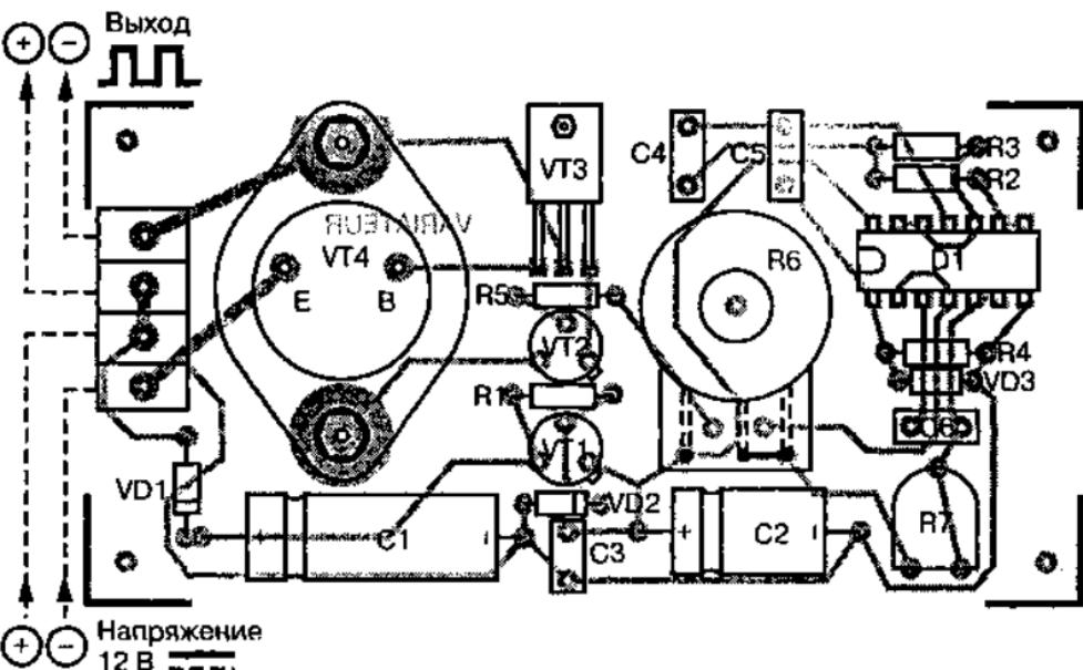
Рис. 4.52. Монтажная схема регулятора скорости вращения дрели
