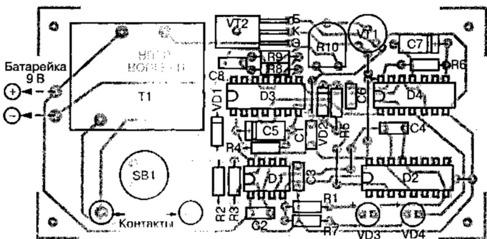
Рис. 4.135. Схема расположения компонентов устройства «русская рулетка»
