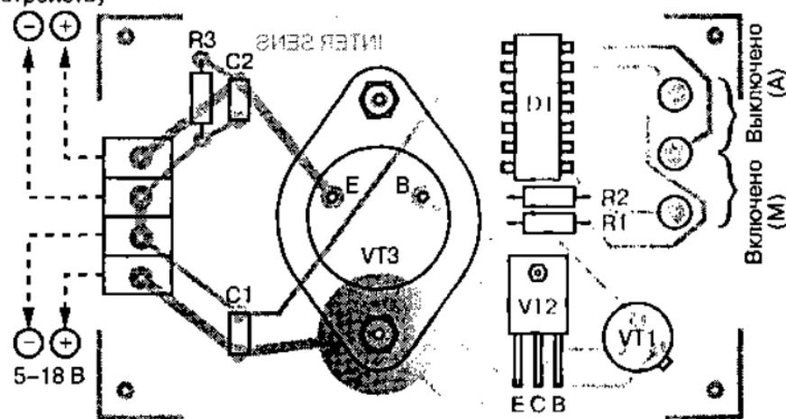
Рис. 4.10. Монтажная схема сенсорного выключателя
