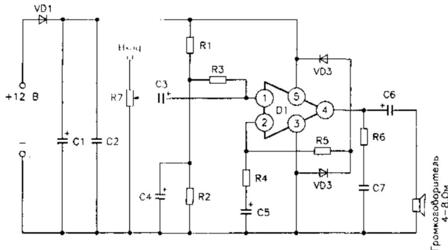
Рис. 4.76. Принципиальная схема усилителя низкой частоты мощностью 7 Вт
