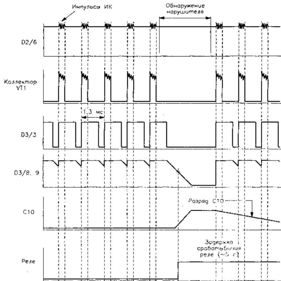
Рис. 4.91. Временная диаграмма работы приемника инфракрасного барьера
