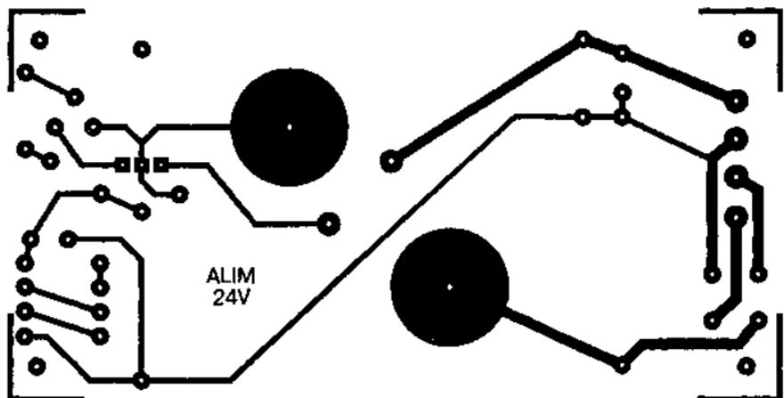
Рис. 4.2. Чертеж печатной платы регулируемого источника постоянного напряжения
