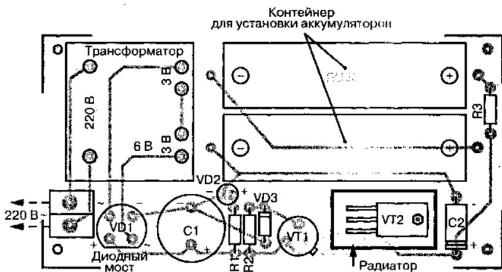
Рис. 4.30. Монтажная схема зарядного устройства
