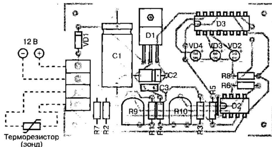
Рис. 4.114. Схема размещения элементов детектора гололедицы
