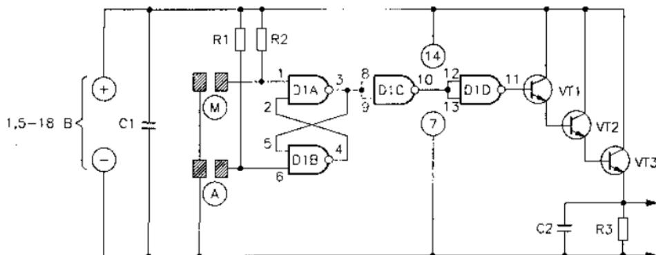
Рис. 4.8. Схема сенсорного выключателя
