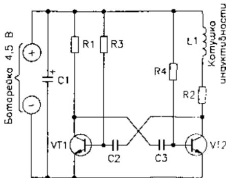
Рис. 4.42. Принципиальная схема широкополосного генератора сигналов
