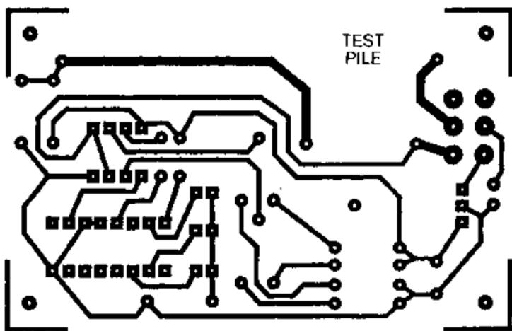
Рис. 4.34. Чертеж печатной платы тестера для батареек
