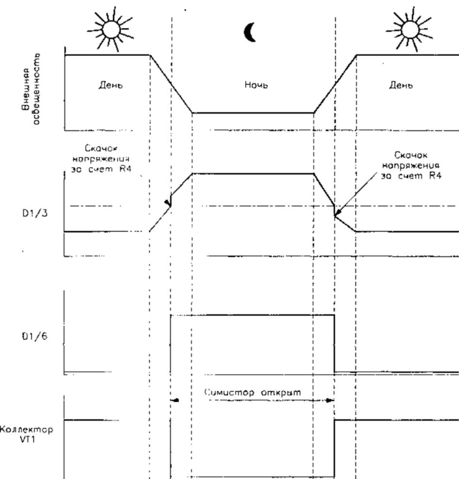
Рис. 4.96. Временные диаграммы работы автоматического выключателя, управляемого внешним освещением
