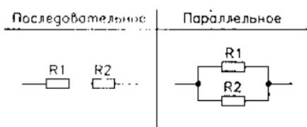
Рис. 1.2. Последовательное и параллельное соединения резисторов
