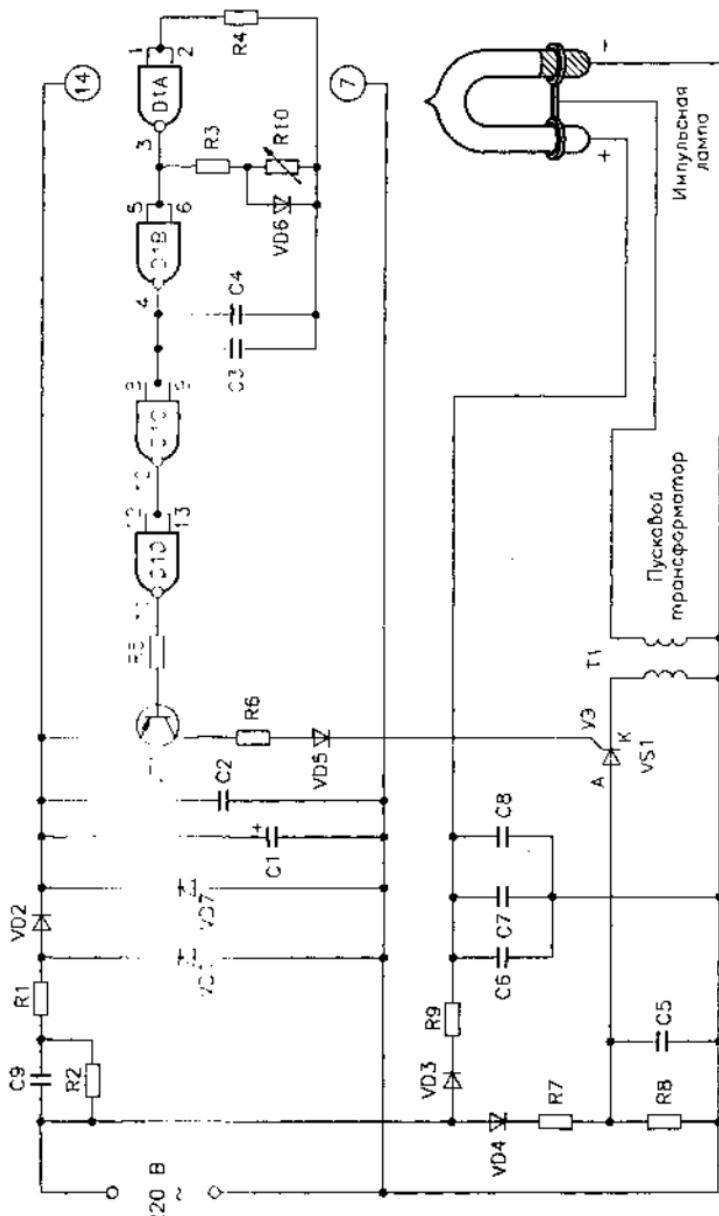
Рис. 4.58. Принципиальная схема стробоскопа
