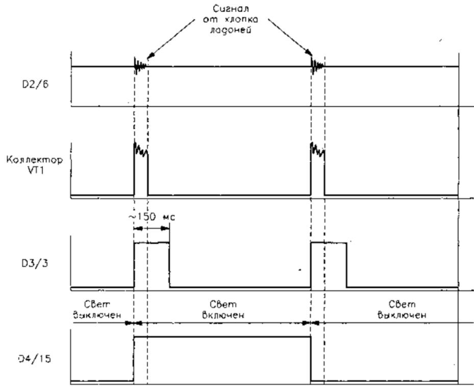
Рис. 4.123. Временные диаграммы устройства звукового управления освещением
