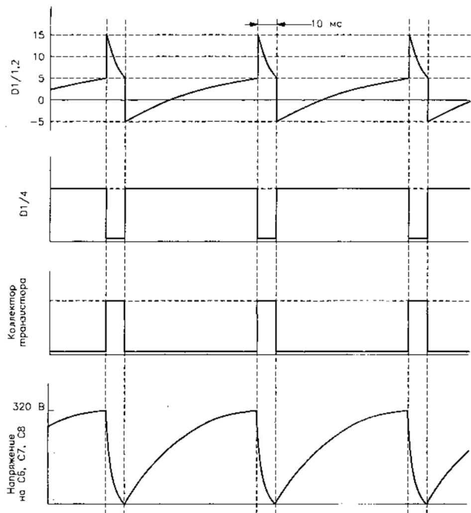
Рис. 4.59. Временная диаграмма работы стробоскопа
