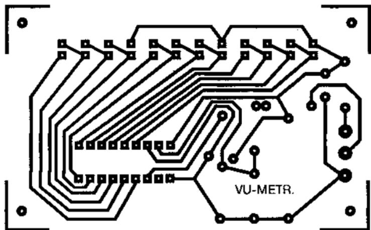
Рис. 4.73. Чертеж печатной платы индикатора уровня сигнала для автомагнитолы
