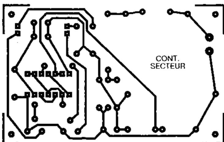
Рис. 4.18. Чертеж печатной платы индикатора отключения сети
