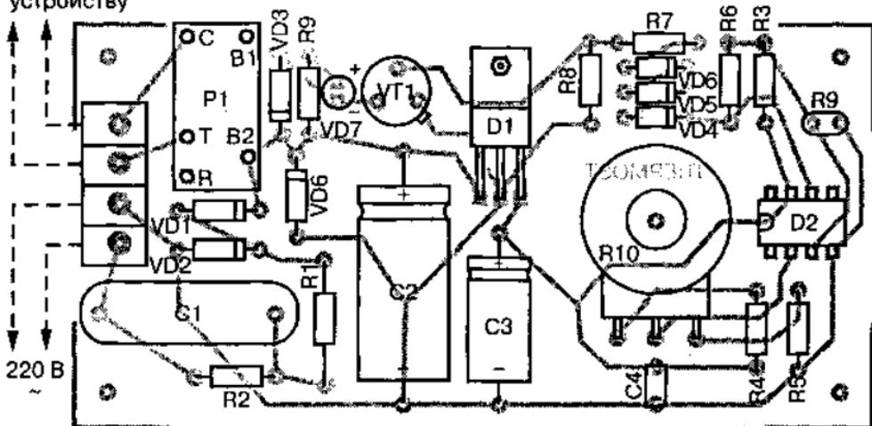
Рис. 4.109. Установка элементов на плате термостата
