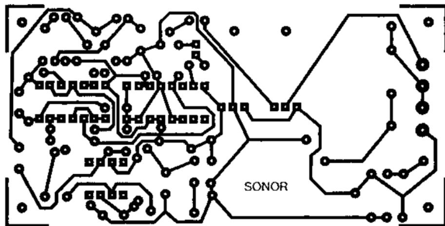
Рис. 4.124. Схема печатной платы устройства звукового управления освещением
