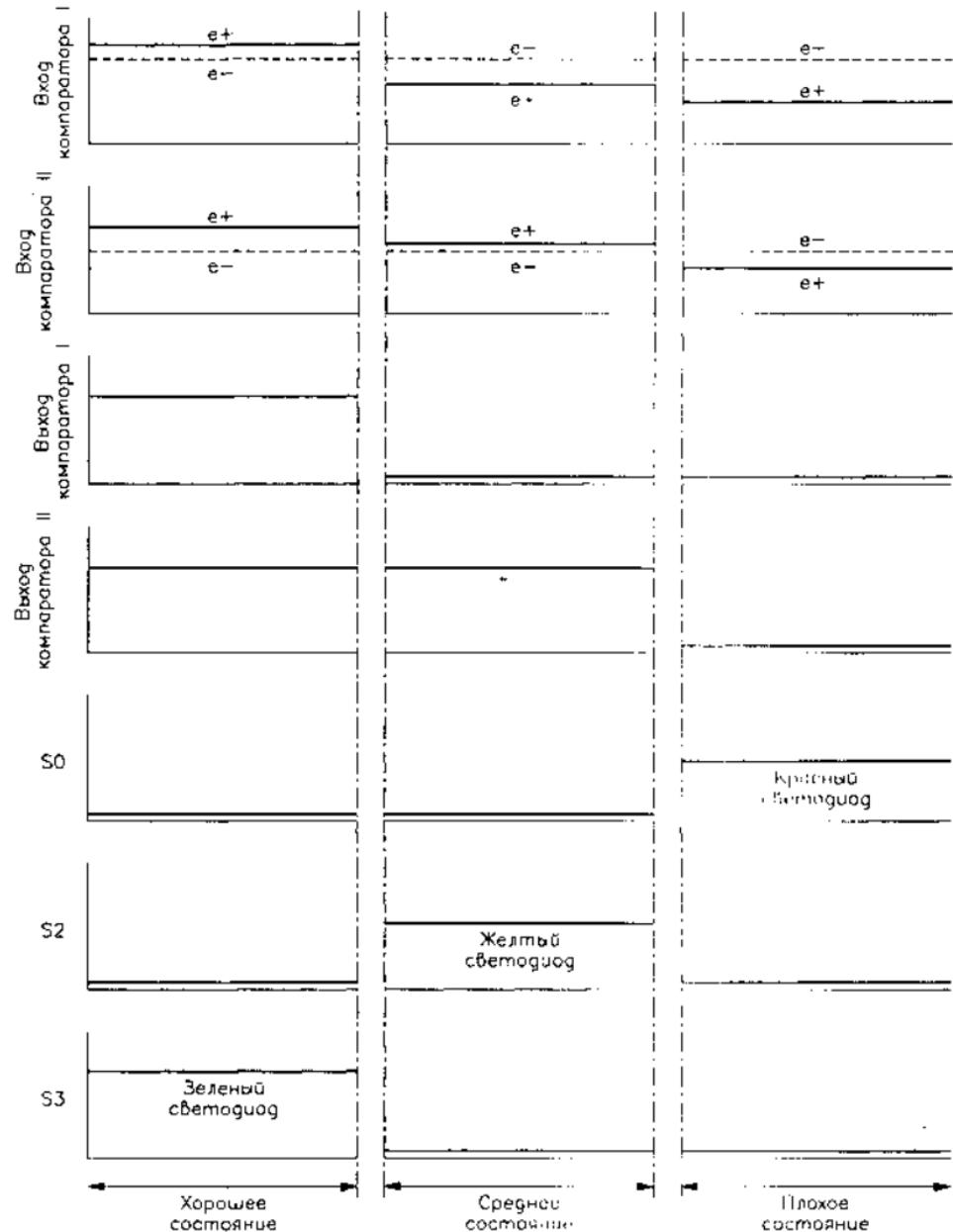
Рис. 4.33. Временные диаграммы работы тестера для батареек
