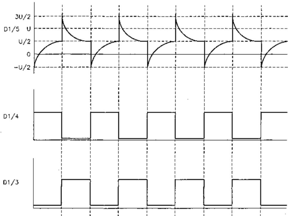
Рис. 4.12. Временная диаграмма мультивибратора
