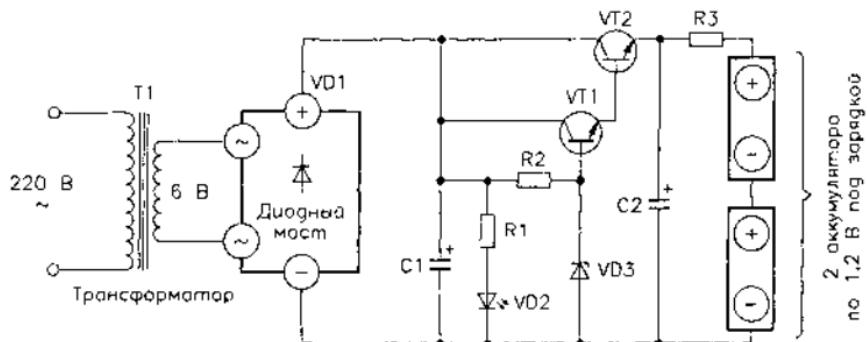
Рис. 4.28. Принципиальная схема зарядного устройства
