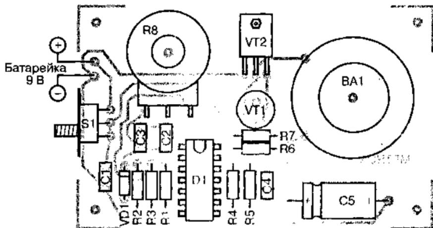
Рис. 4.83. Линейная схема метронома
