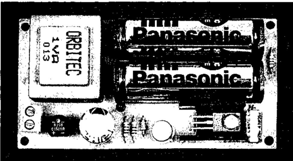
Рис. 4.31. Общий вид зарядного устройства
