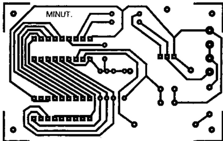
Рис. 4.102. Чертеж печатной платы сетевого программируемого таймера
