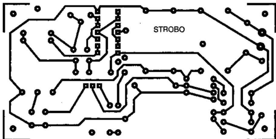
Рис. 4.60. Чертеж печатной платы стробоскопа
