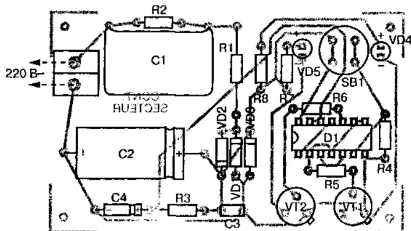
Рис. 4.19. Монтажная схема индикатора отключения сети
