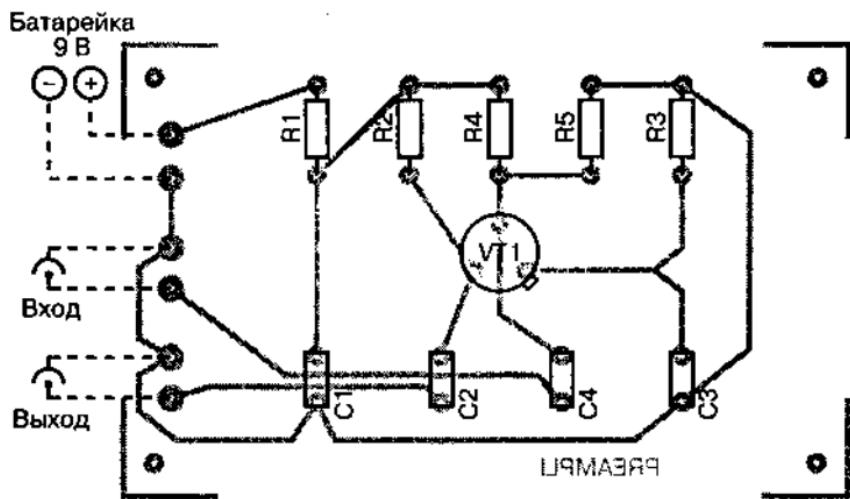
Рис. 4.22. Монтажная схема антенного усилителя
