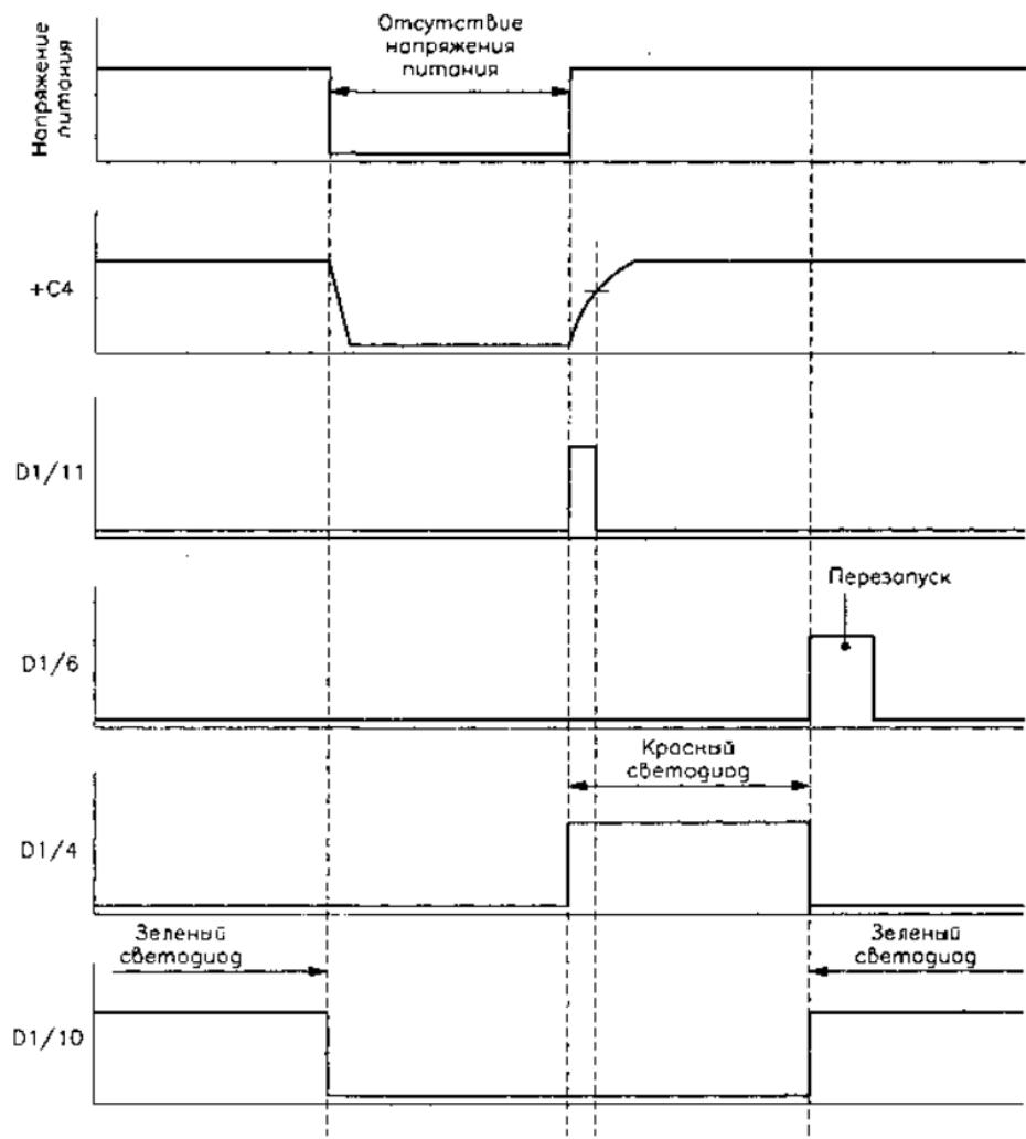
Рис. 4.17. Временная диаграмма работы индикатора отключения сети
