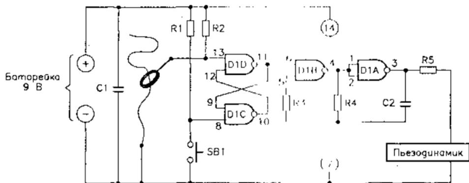
Рис. 4.11. Принципиальная схема «игры на ловкость»
