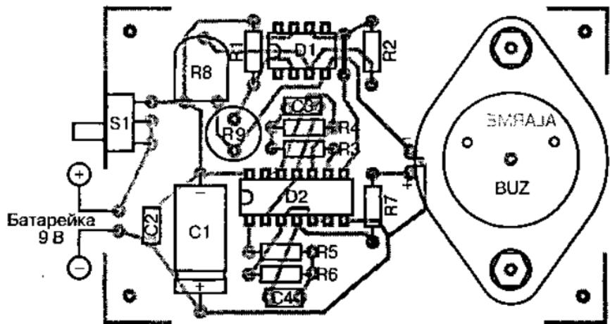
Рис. 4.70. Установка элементов устройства на печатной плате
