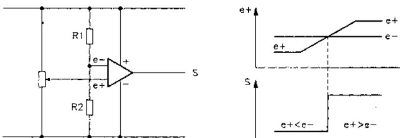
Рис. 3.16. Компаратор напряжения на ИС  $\mu$ A741
