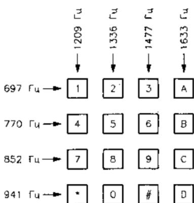
Рис. 3.21. Матрица частотного
