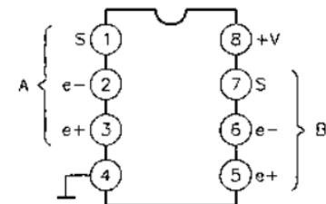
Рис. 3.17. Сдвоенный операционный усилитель LM358
