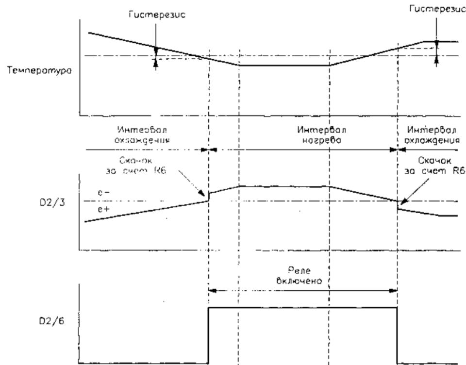
Рис. 4.106. Временная диаграмма работы термостата (пример регулировки при 20 °C)
