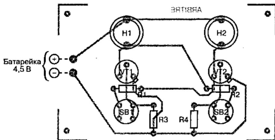
Рис. 4.6. Монтажная схема «электронного арбитра»
