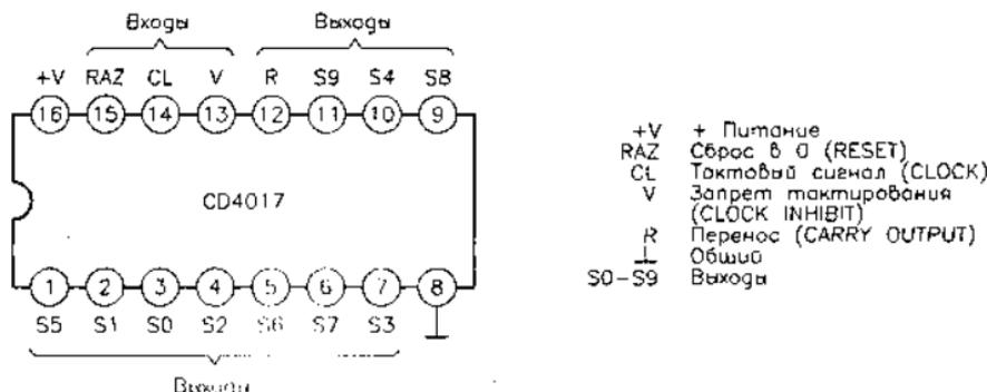
Рис. 3.8. Десятичный счетчик-декодер CD4017
