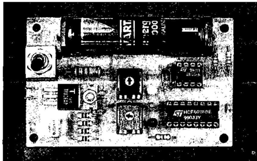
Рис. 4.36. Общий вид собранного тестера для батареек
