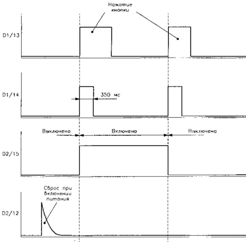
Рис. 4.54. Временная диаграмма работы сетевого дистанционного выключателя
