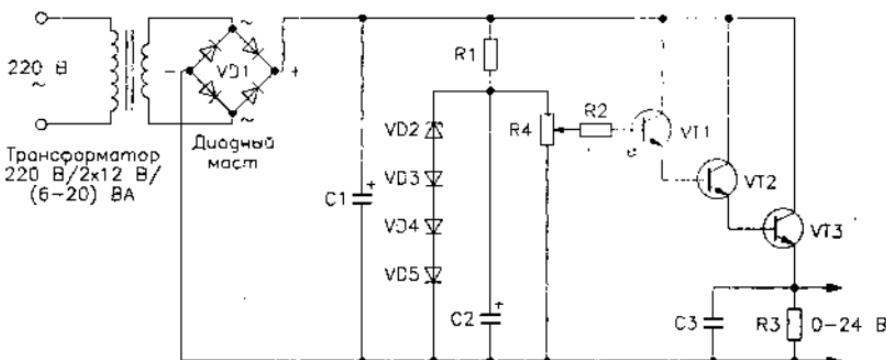
Рис. 4.1. Принципиальная схема регулируемого источника постоянного напряжения
