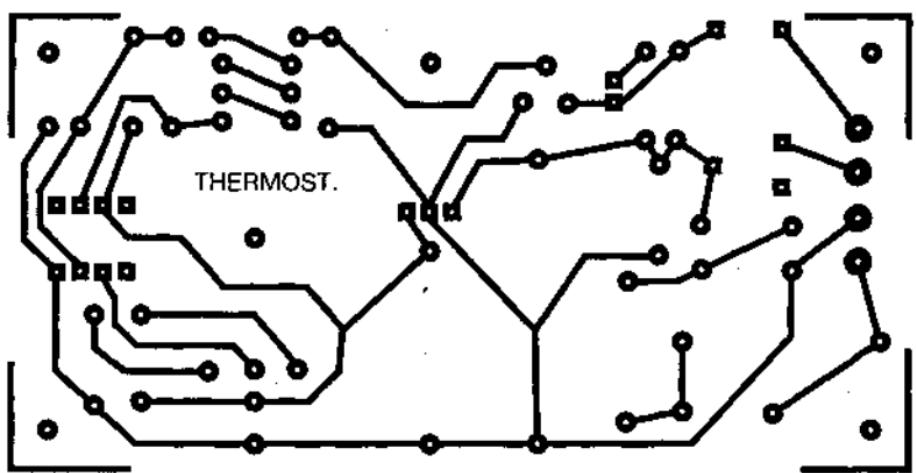
Рис. 4.108. Чертеж печатной платы термостата
