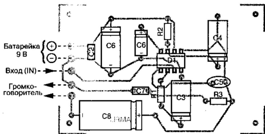
Рис. 4.65. Установка компонентов низкочастотного усилителя на печатной плате
