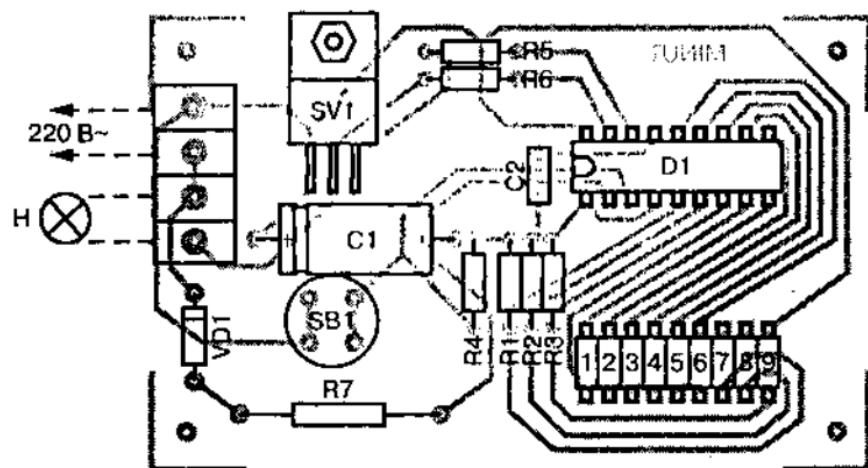
Рис. 4.103. Установка компонентов на плате сетевого программируемого таймера
