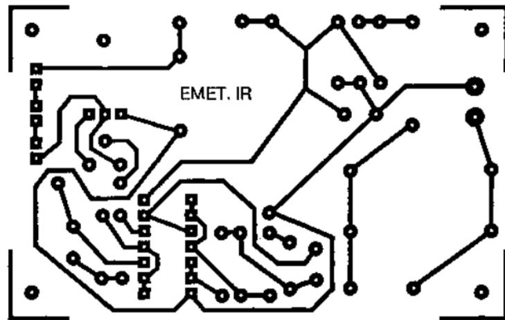
Рис. 4.87. Схема печатной платы излучателя инфракрасного барьера
