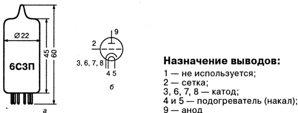
Рис. 2.60. Лампа 6С3П: а — основные размеры; б — схематическое изображение
